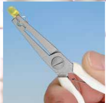
Les pinces de coupe et de formage 341A réduisent les tensions dans les fils des composants et les coupent à la longueur voulue en une seule pression.
