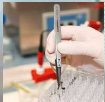
Les brucelles en fibre de carbone 249CFR-SA sont souvent utilisées dans les applications médicales et de laboratoire lors de la manipulation de composants sensibles ou lorsqu'une résistance chimique est nécessaire.
