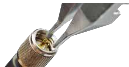
La pince coupante miniature 7292MI est utilisée pour couper un fil de terre à l'intérieur d'un mini connecteur.
