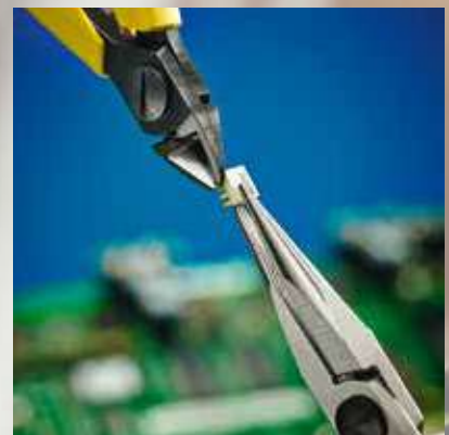
La pince coupante à tête ovale 8140 et la pince à bec à bec court 7891 sont grandement utilisées pour le travail sur harnais de câbles et l'assemblage.
