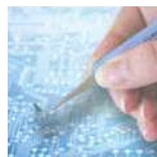
Brucelles 51S-SA-ET : sécurisée ESD, poignées Ergo-Touch compatibles avec les salles blanches.
