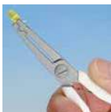
Les pinces de coupe et de formage 341A réduisent les tensions dans les fils des composants et les coupent à la longueur voulue en une seule pression.
